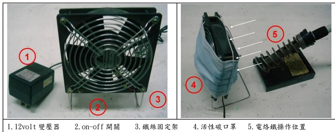
1. 12volt 變壓器 2. on-off 開關 3. 鐵絲固定架 4. 活性碳口罩 5. 電烙鐵操作位置
