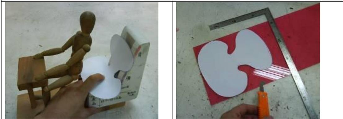
可以利用輪廓背板檢測材料放樣的尺寸是否適當，再切割需要的材料
