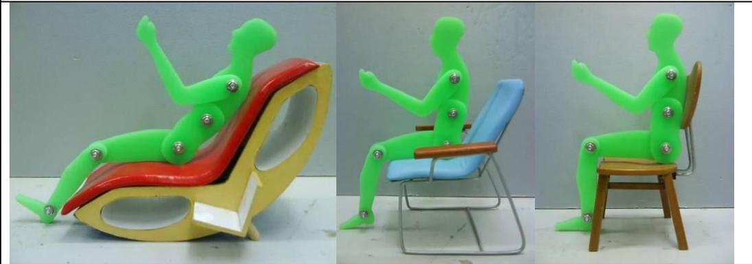
側面人型板可以用來解說不同類型座椅的乘坐姿勢，與人體需求的设计限制
