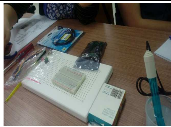
實驗器材：麵包板、Arduino、pH sensor
