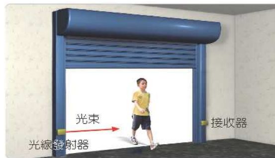
圖 8-5 小孩通過正在關閉的車庫門時，會阻擋住發射器的光線，電流瞬間被切斷，車庫門也將馬上停止。
