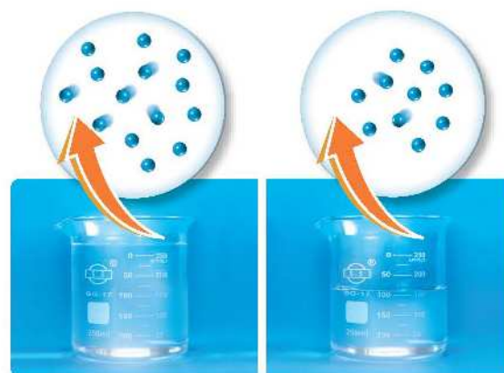
圖 7-9 雖然兩杯子內的水溫度相等，但水量較多的杯子內部所含水分子之總動能，較水量較少的杯子內部所含水分子之總動能大。
