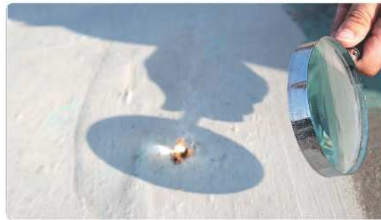
圖 7-11 光通過凸透鏡可使薄木屑燃燒
