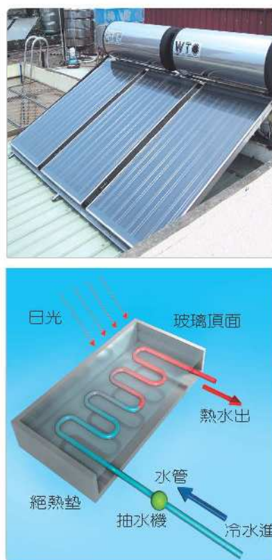
圖 7-24 太陽能熱水器與原理示意圖
