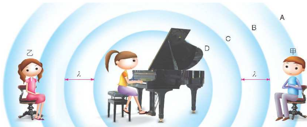
圖 6-14 鋼琴演奏時，坐在不同位置的聽眾會聽到相同的演奏音調，這是因聲源靜止時，甲、乙聆聽到的聲波波長（圖中以 \lambda 表示），皆等於聲源發出的聲波波長；也表示甲、乙聆聽到的聲波頻率，等於聲源發出的聲波頻率。
