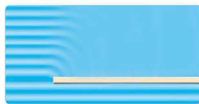
圖 6-11 直線形水波遇到障礙物後，可看到波會擴散到障礙物後方，稱為水波之繞射。
