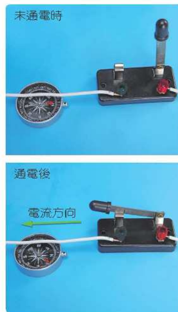
圖 5-1 直導線未通電時，與磁針方向平行，皆在南北方向。通電後磁針方向偏轉，表示此直導線載有電流時，會產生東西向的磁場。
