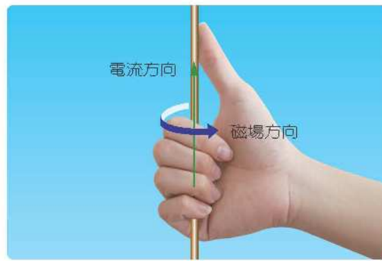
圖 5-2 右手定則：電流方向沿著拇指時，所產生的磁場之磁力線沿四指方向環繞。
