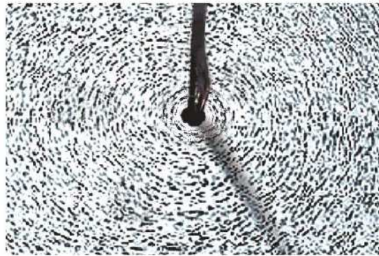
圖 5-3 載流直導線產生的磁場使周圍的鐵粉排成同心圓
