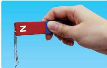
圖 4-11 磁鐵吸引被磁化的迴紋針，若移開磁鐵，則迴紋針磁性消失。
