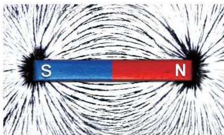
圖 4-12 磁鐵周圍的鐵粉排成磁力線的形狀
