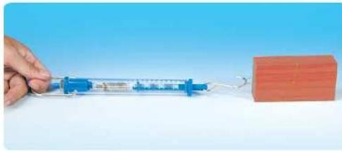
圖 3-21 彈簧秤亦可用來測量拉力的量值
