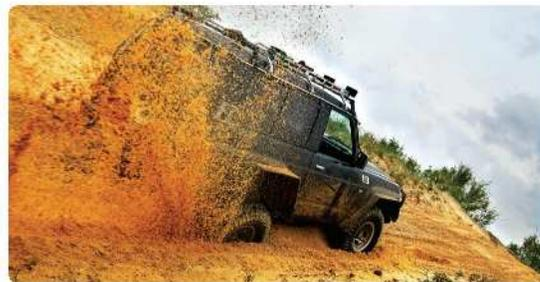
圖 3-29 在泥沼中的輪胎與地面摩擦力非常小，使得輪胎不斷空轉而無法前進。
