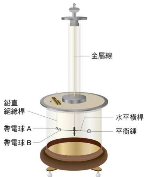
▲圖 6-9 庫侖進行扭秤實驗示意圖，證實兩點電荷間的靜電力與距離的平方成反比的關係。
