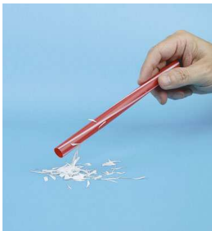
▲圖 6-2 帶電的塑膠吸管吸引紙片。
