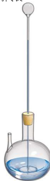
▲圖 1-13 伽利略很早就利用定量氣體受熱膨脹的原理，製成溫度計。圖中玻璃瓶中空腔部分的氣體受熱膨脹會擠壓使細管中的液體上升。
