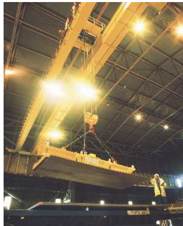
▲圖 8-26 工業用的電磁鐵起重機，可搬運鐵製物品，或用以區分磁性和非磁性物件。
