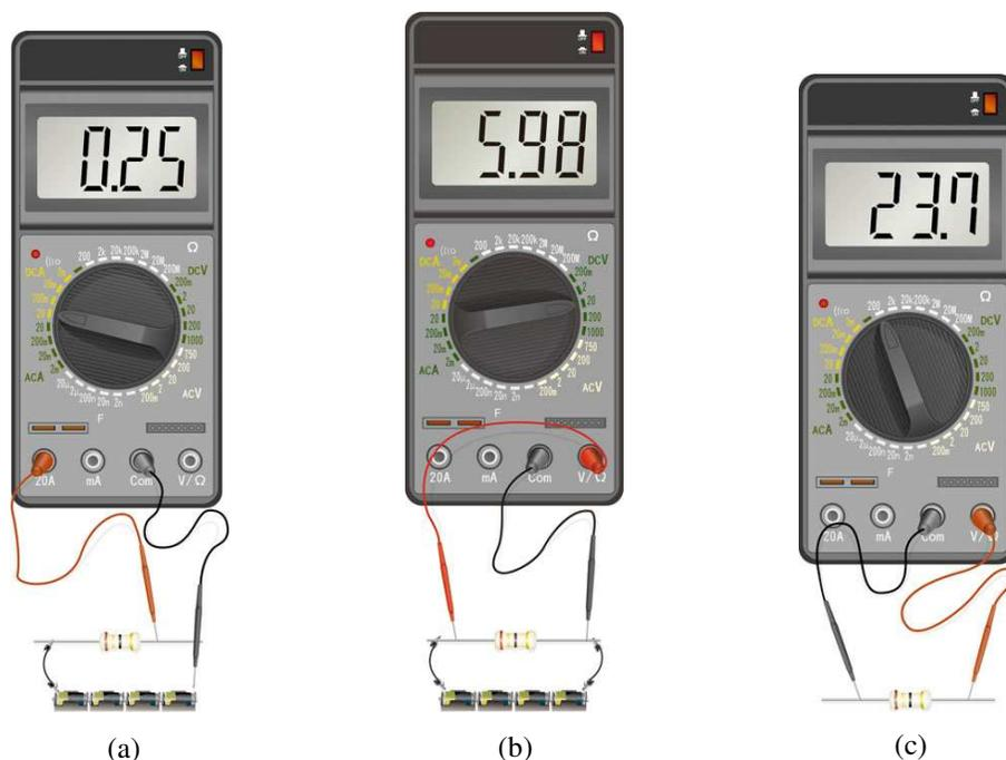
▲圖 7-18 使用三用電表(a)測量電流；(b)測量電壓；(c)測量電
