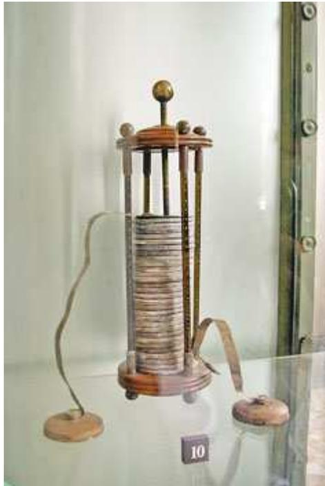
▲圖 7-1 將含食鹽水的溼布夾在銀和鋅的圓板中間，按銀、布、鋅、銀、布、鋅……的次序堆疊，用導線連接最頂端的銀板和最底層的鋅板，如此便可製造稱為伏打堆的電池。
