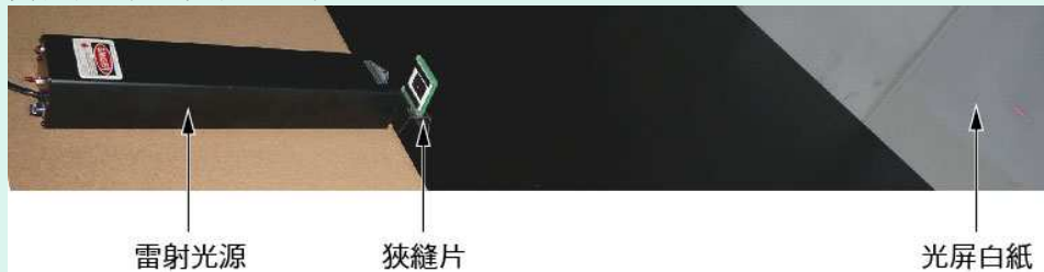
▲圖 5-13 以雷射光作光源進行雙狹縫干涉實驗。
