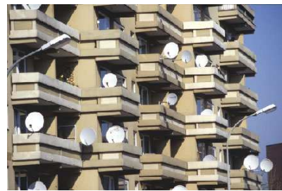
▲圖 4-7 部分住戶裝設拋物面鏡製成的碟形天線（俗稱小耳朵）來接收衛星電視。
