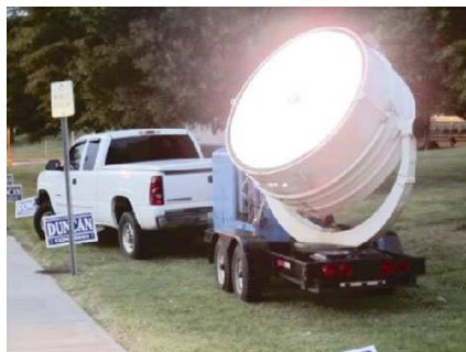
▲圖 4-9 強力探照燈的光源置於拋物面鏡的焦點處。
