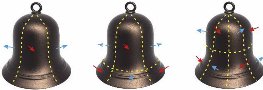
▲圖 3-15 於某一瞬間，鐘的數種可能振動方式（藍色箭頭代表鐘面往外凸出，紅色箭頭代表鐘面往內凹入，黃色虛線則為節線）。
