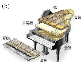
▲圖 3-21 幾種弦樂器的共鳴裝置，(a)小提琴的音箱；(b)鋼琴的共鳴板；(c)豎琴的共鳴板。
