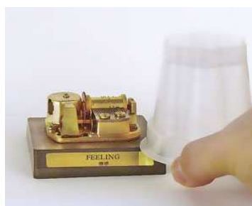
▲圖 3-20 將一個洗淨的布丁杯（乳酸飲料空瓶亦可）的一部分緊貼音樂盒的底座。
