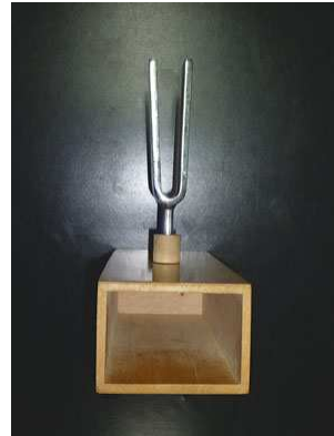
▲圖 3-16 固定於音箱上的音叉，可以發出較大的響聲。
