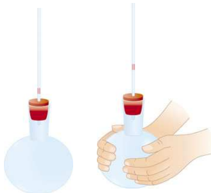
▲圖 1-11 手握瓶子，手溫使瓶內的氣體受熱膨脹，驅使細管中的紅墨水向上移動。
