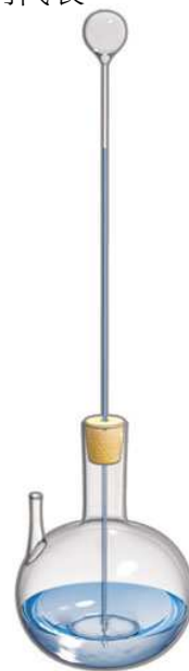
▲圖 1-13 伽利略很早就利用定量氣體受熱膨脹的原理，製成溫度計。圖中玻璃瓶中空腔部分的氣體受熱膨脹會擠壓使細管中的液體上升。
