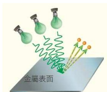
▲圖 8-3 入射光強度愈大，金屬表面所放出的光電子數量就愈多。
