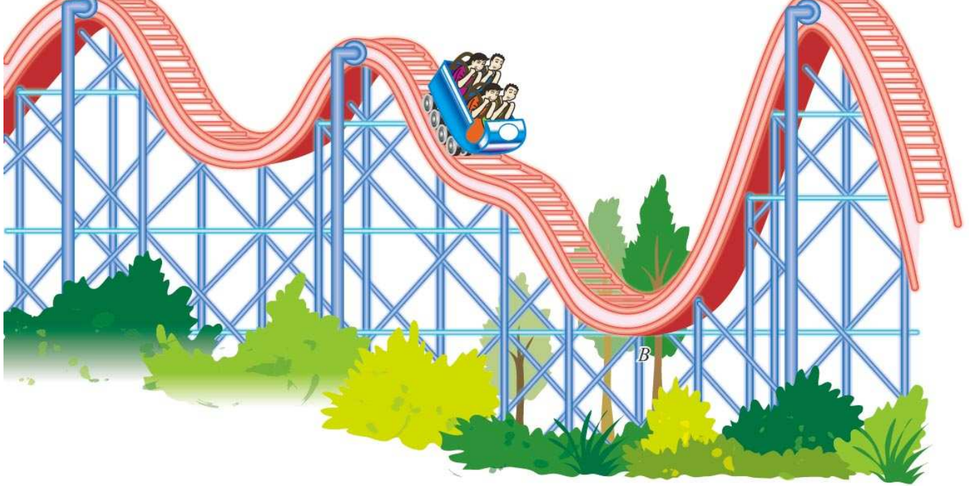
▲ 圖 7-1 雲霄飛車移動過程的動能與位能轉換。
