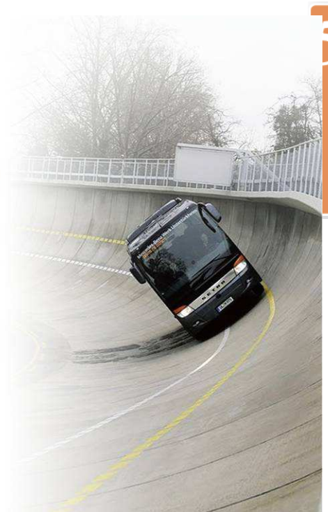
∴ 圖 5-7 (a) 车子在光滑路面轉彎時，路面的正向力可以提供車子轉彎時所需的向心力。(b) 車子的受力分析圖。
