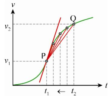
∴圖 1-15 在  $v-t$  圖中，切線斜率等於在  $t_1$  時刻的瞬時加速度。
