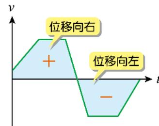
∴圖 1-12  $v-t$  關係圖曲線與  $t$  軸所圍的面積代表位移的量值，正負代表位移的方向。
