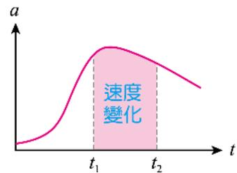
∴圖 1-16  $a-t$  關係圖曲線和時間軸所包圍的面積，等於質點運動之速度變化。
