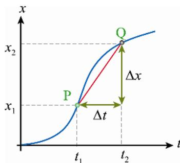
∴ 圖 1-7 在  $x-t$  圖中，任取兩點連線的斜率，即此段時間間隔內的平均速度。
