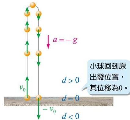
圖 1-23 拋體運動以起始位置為原點，位移符號向上為正，向下為負。
