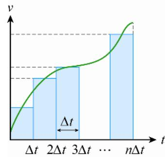
∴圖 1-10 將全程分為  $n$  個時間間隔，當  $n$  增大時，每個  $\Delta t$  內的速度變化將變小。
