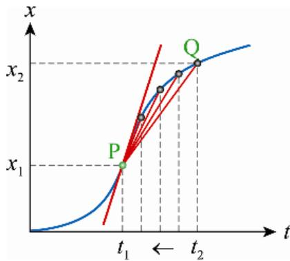
∴圖 1-8 在  $x-t$  圖中， $t_1$  時刻的切線斜率即質點在  $t_1$  時刻的瞬時速度。
