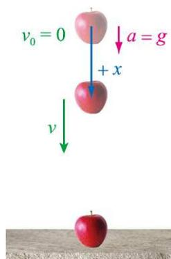
∴ 圖 1-21 由靜止自由落下的物體。以起始位置為原點，向下取正號，向上取負號。
