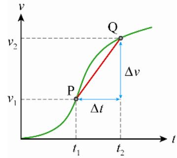
∴圖 1-14 在  $v-t$  圖中，P、Q 兩點連線的斜率，等於此段時間間隔內的平均加速度。
