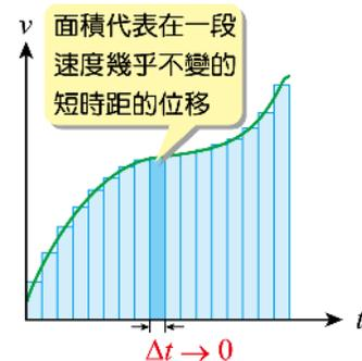
∴圖 1-11  $v-t$  關係圖曲線下的面積等於質點所經的位移，若時間間隔  $\Delta t$  趨近於零，則長條面積總和等於  $v-t$  關係圖下所圍的面積。
