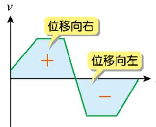
∴圖 1-11  $v-t$  關係圖曲線與  $t$  軸所圍的面積代表位移的量值，正負代表位移的方向。
