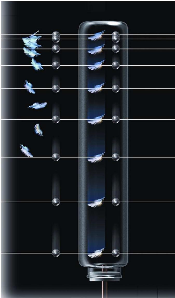
圖 1-19 自由落體運動的實驗圖，左邊是在空氣中，右邊管內為真空，橫線間隔標示單位時間。
