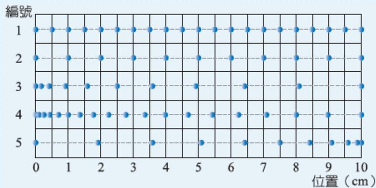
**思路：**等速運動在相同的時間間隔  $\Delta t$  內位移  $d = v\Delta t$  均為定值，故打點均勻分布。等加速運動因速度均勻增加（或均勻減小），相同的時間間隔  $\Delta t$  內位移不為定值，打點間隔將漸大(或漸小)。
