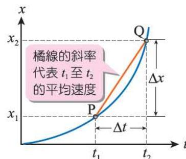
∴圖 1-7 在  $x-t$  圖中，任取兩點連線的斜率，其數值等於此段時間間隔內的平均速度。
