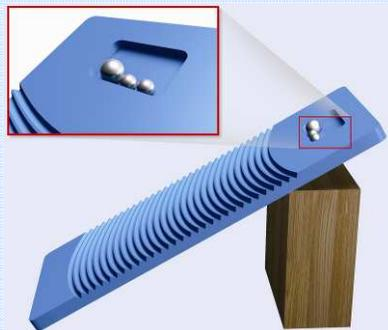
2. 取重量不同的二鋼珠由洗衣板上端靜止釋放，由聲音判斷二鋼珠之運動型態是否相同。
