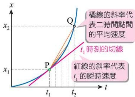
∴ 圖 1-8 在  $x-t$  圖中， $t_1$  時刻的切線斜率即質點在  $t_1$  時刻的瞬時速度。
