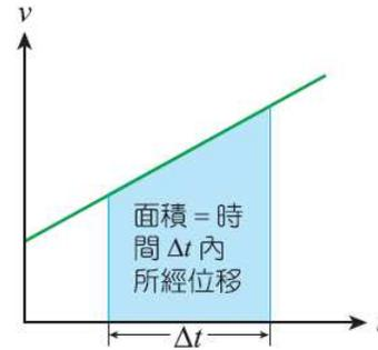
∴圖 1-10  $v-t$  圖曲線下的梯形面積等於質點所經的位移。
