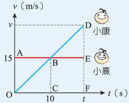
**解** (1) 速度為  $v-t$  圖之縱坐標，10 秒前小熹的速度量值較大；
