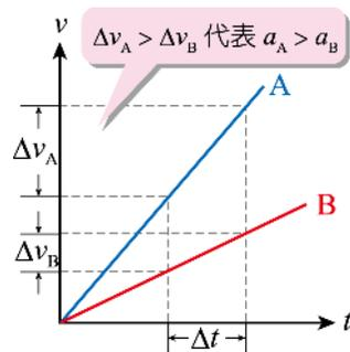
∴圖 1-15 在  $v-t$  圖中，斜率愈大表示加速度愈大，圖中 A 的加速度  $a_A$  大於 B 的加速度  $a_B$ 。
