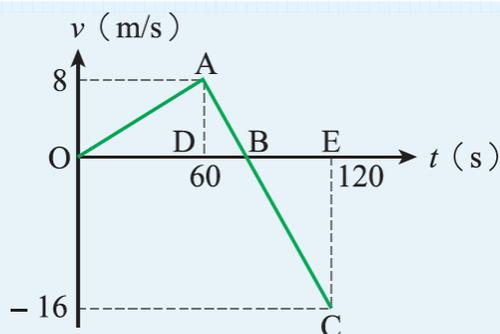
**思路：**  $v-t$  圖的圖線下面積為位移。速度  $v$  為正值，位移增加；速度  $v$  為負值，位移減小；當  $v=0$  時，物體的位移達到最大值。
