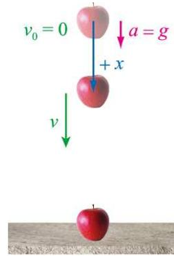
∴圖 1-20 由靜止自由落下的物體以起始位置為原點，向下取正號，向上取負號。
