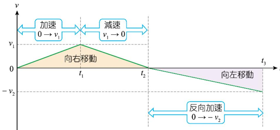
∴圖 1-12 在此  $v-t$  關係圖中，若時間軸上、下方所包圍的面積相等，則表示火車會於  $t_3$  時刻行經原出發點。
