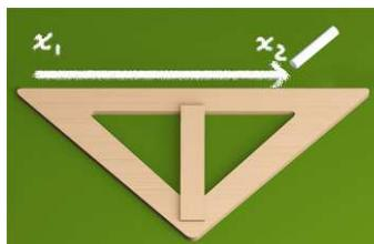
∴圖 1-2 粉筆位移的量值是粉筆經尺所畫出線段的長度，方向則由  $x_1$  指向  $x_2$ 。
